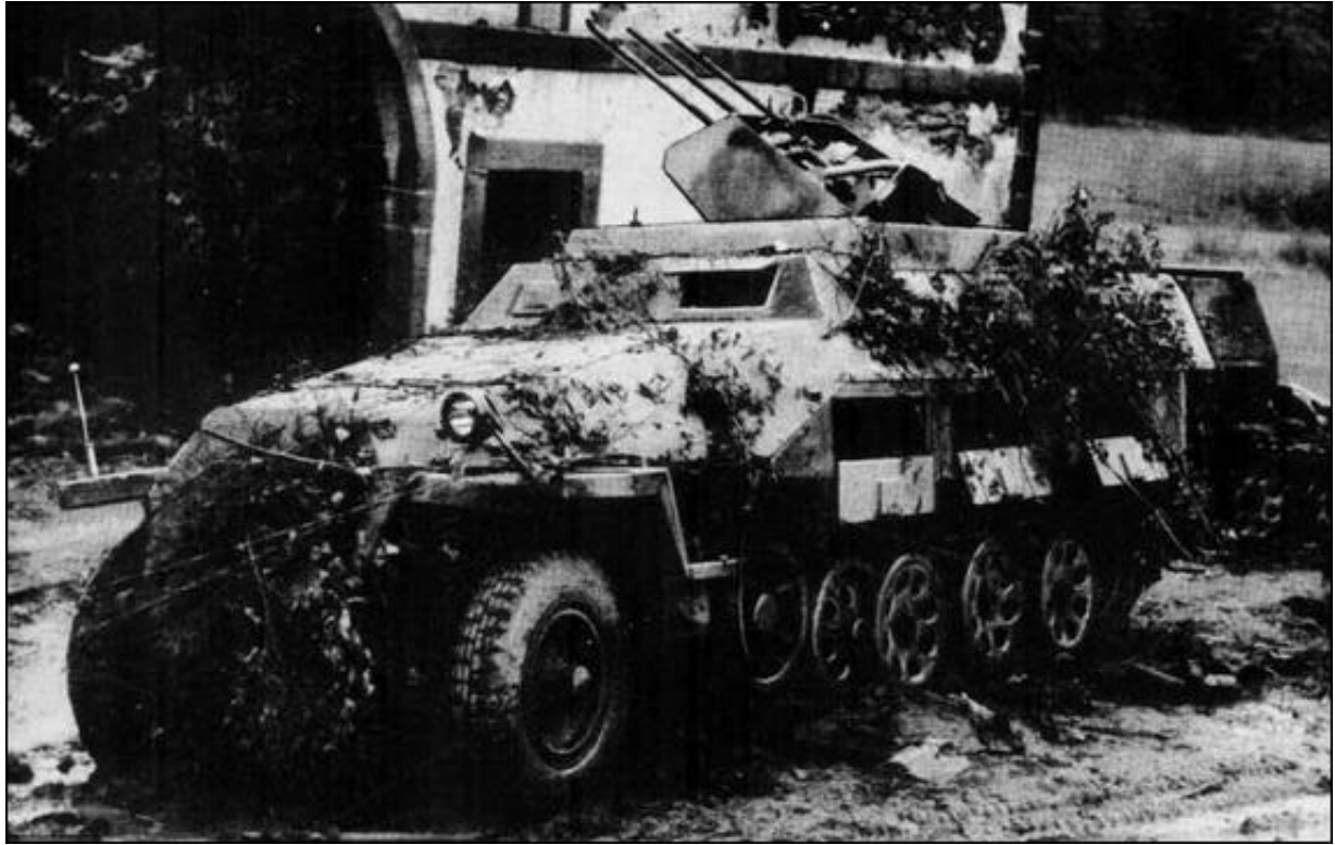
Hanomag Sd.Kfz 251/21 – Duitse half-track met het drie-loops 15 mm of 20 mm-machinegeweer.
